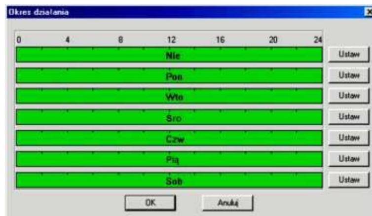
Rys. 7-38a. Ustawianie okresu aktywności wejścia alarmowego.
